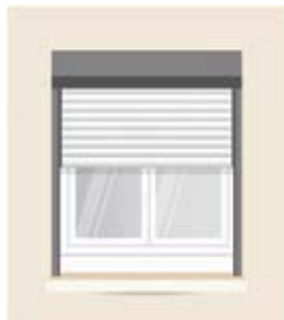
Type B : pose en tableau intérieur
