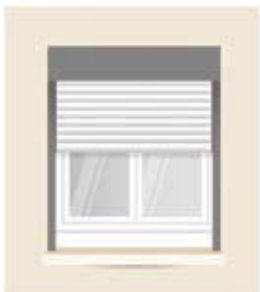
Type A : pose en tableau extérieur
