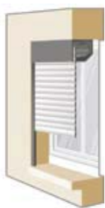
Type A : pose en tableau extérieur
