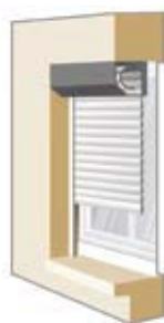
Type B : pose en tableau intérieur
